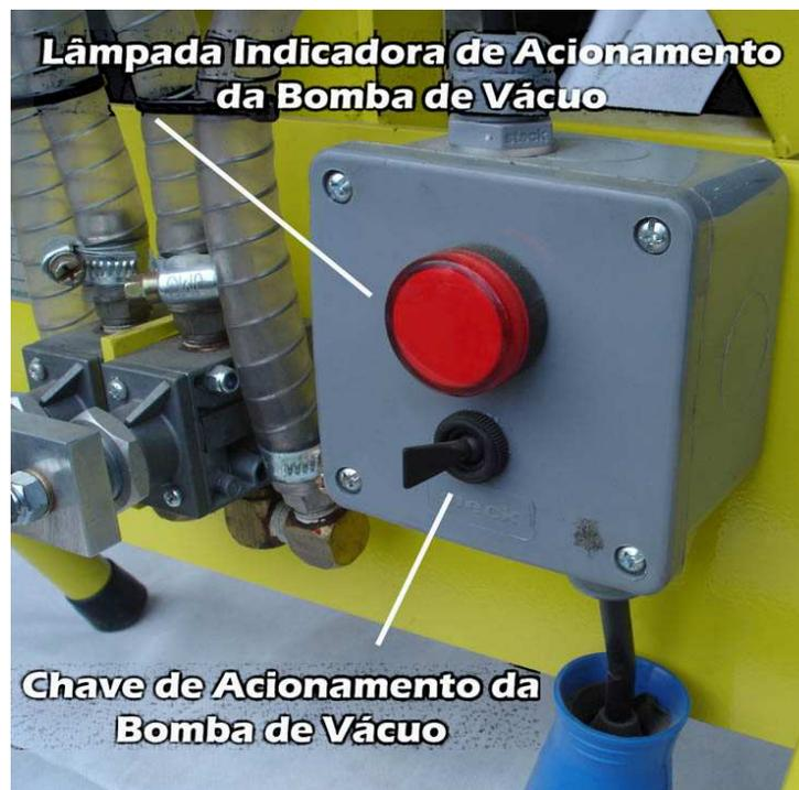
Com a bomba de vácuo ligada, direcionar o equipamento no **centro** da peça de vidro, encostar as ventosas no vidro e aguardar o sistema carregar.
